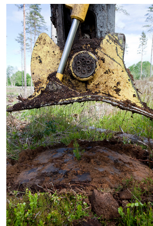
P11.a pflanzt stets mit derselben Pflanztiefe in die Mitte der Haufen und sorgt somit für eine optimale Produktion und Überlebenschancen.
